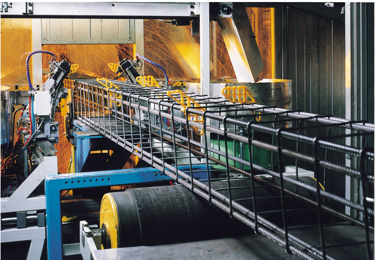
Abb. 2 Herstellung der Bewehrungskörbe und Montage der Abstandshalter
